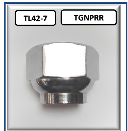
TUERCA LUJO, CHEV. NPR, HINO, M20 X 1.50, DERECHA, SELLADA PLANA, HEXAGONO 41MM O 1-5/8", ALTO 38MM
