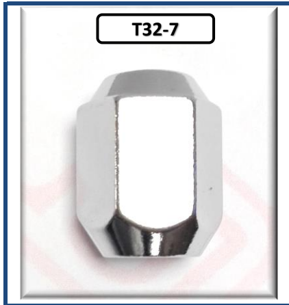
TUERCA LUJO, TOYOTA VIGO, M14 X 1.50 X 35, HEXAGONO DE 23MM O 15/16", DERECHA, ALTO 36MM
