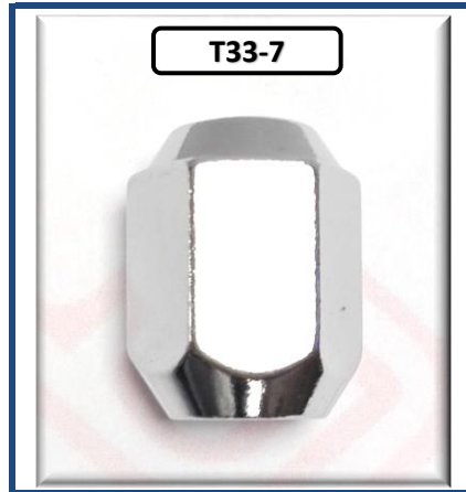
TUERCA LUJO, TOYOTA VIGO, M14 X 1.50 X 35, HEXAGONO DE 23MM O 15/16", IZQUIERDA, ALTO 36MM
