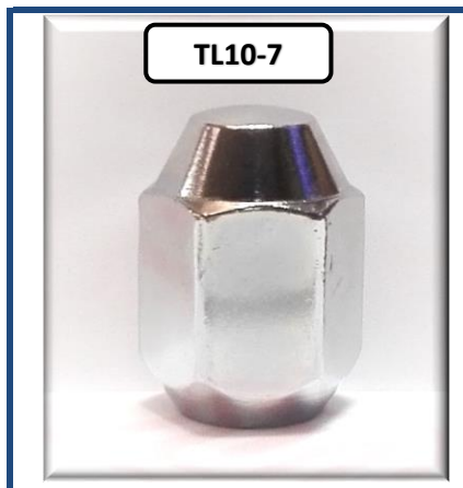
TUERCA LUJO, FORD AUTOS, 1/2", CONICA, HEXAGONO 21MM O 13/16", ALTO 36MM
